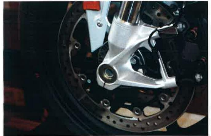
Das vormontierte Pad mit Stange von links durch die Achse schieben.
