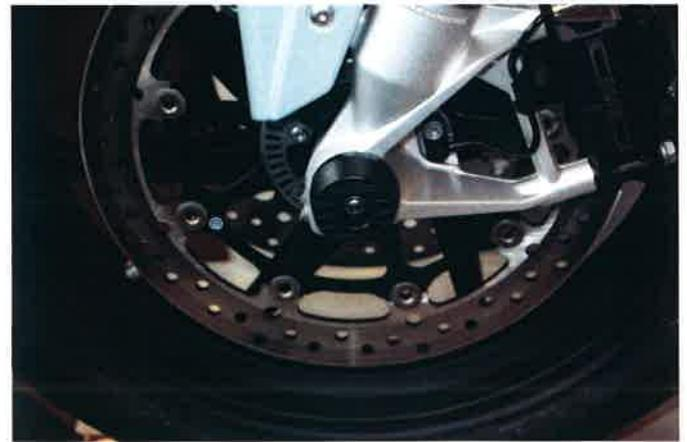
Von der rechten Seite das Pad mit der Unterlegscheibe und Mutter montieren.
